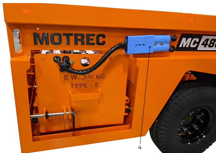
Figure 24. Isolation électrique (Compartiment à batteries extractible).
