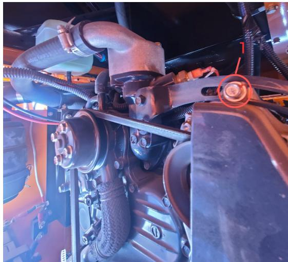
Figure 35. Ajustement de la tension de la courroie.
