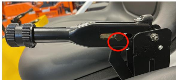
Figure 50. Position de la goupille à axe de chape.
