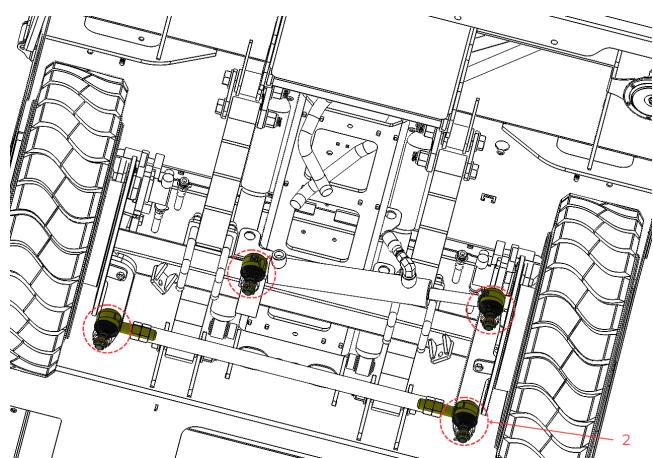
Figure 32. Inspection des rotules de direction.
