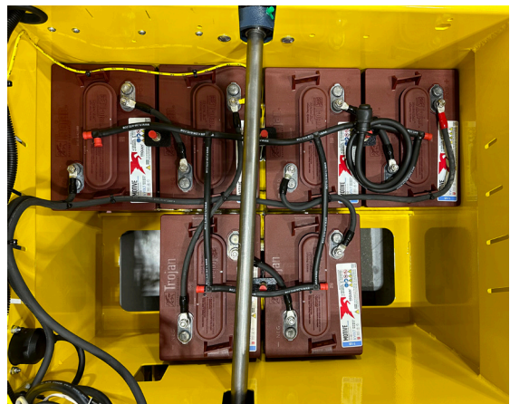
Figure 51. Système d'arrosage des batteries.
