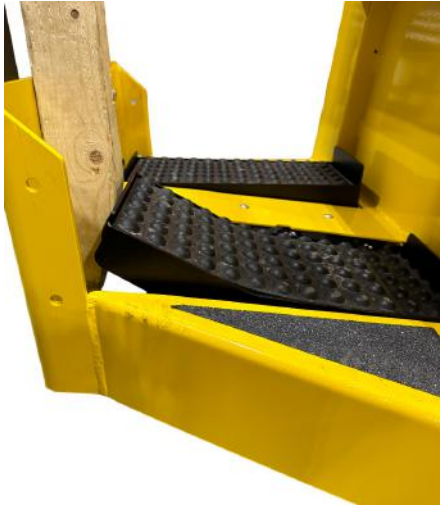
Figure 51. Illustration du blocage de la pédale.
