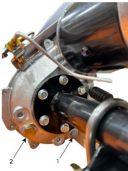
Figure 39. Changement d'huile du boîtier Schafer.
