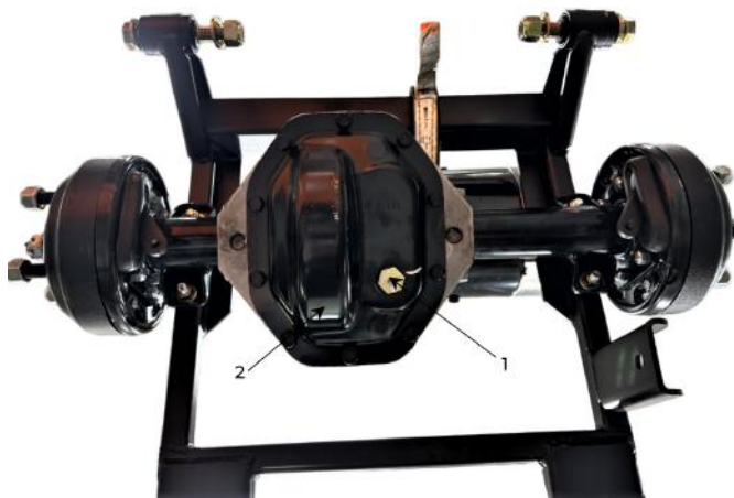
Figure 40. Changement d'huile du boîtier DANA
