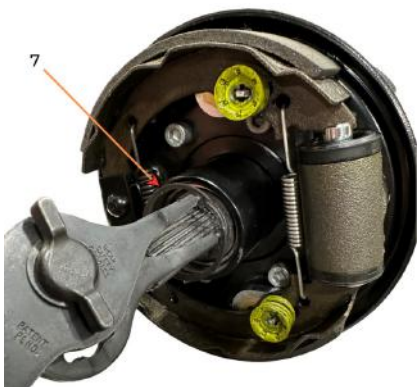
Figure 55. Démontage du circlip et de l'arbre.
