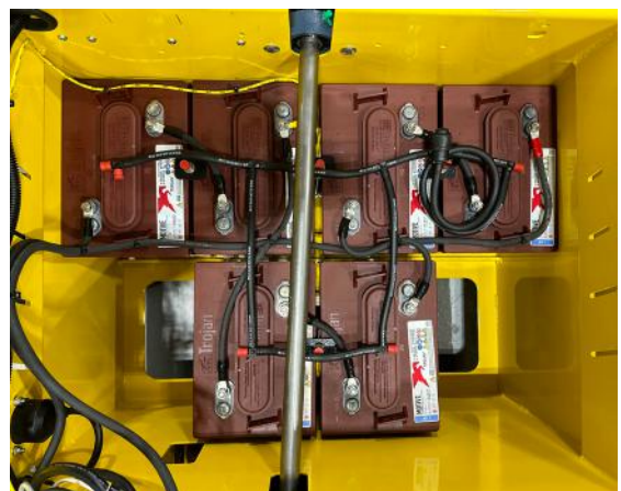
Figure 60. Système d'arrosage des batteries.
