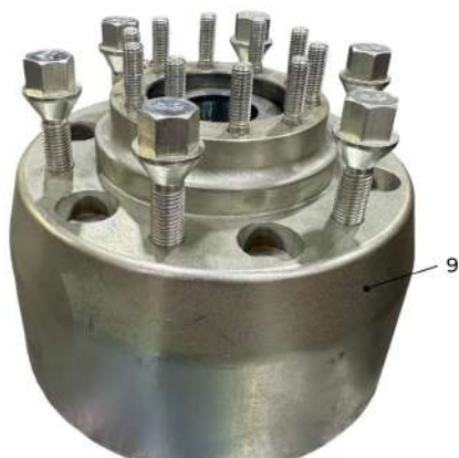
Figure 52. Retrait des goujons de roue et du tambour de frein.
