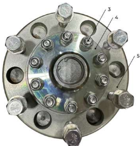
Figure 61. Retrait des boulons et du couvercle du moyeu de l'essieu.
