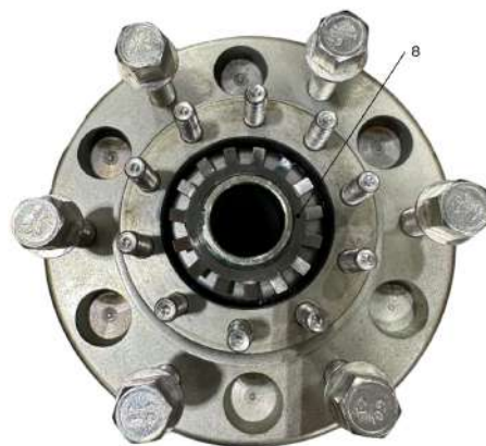
Figure 51. Retrait de la rondelle de blocage.
