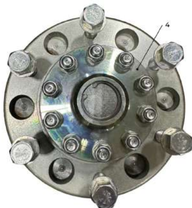
Figure 48. Démontage du couvercle de moyeu d'essieu.
