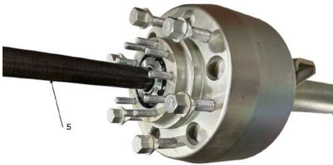
Figure 65. Retrait de l'arbre de l'essieu arrière.
