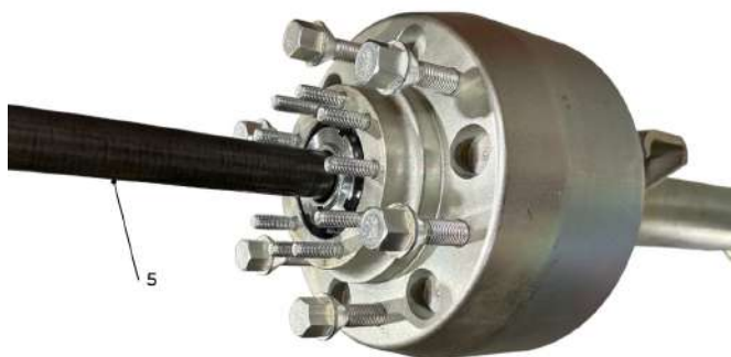
Figure 49. Retrait de l'arbre de l'essieu arrière.
