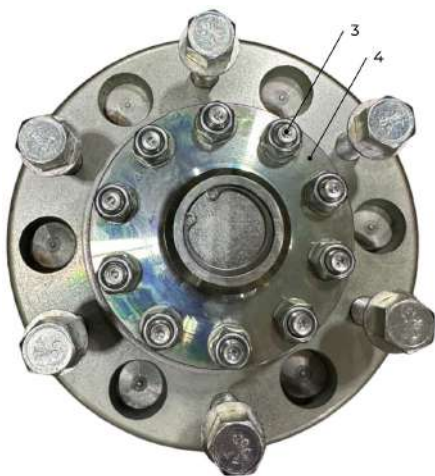
Figure 64. Retrait des boulons et du couvercle du moyeu de l'essieu.
