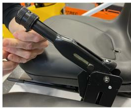
Figure 48. Handbrake Adjustement.
