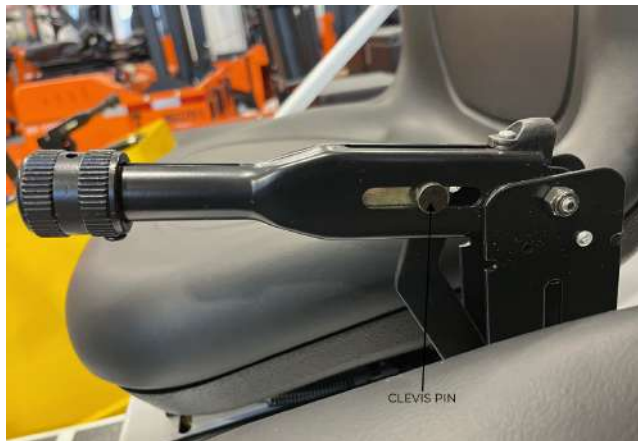
Figure 44. Position de la goupille de chape.
