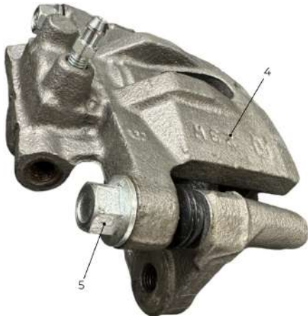
Figure 40. Retrait des goupilles coulissantes et de l'étrier.
