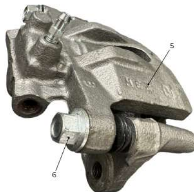
Figure 47. Retrait des goupilles coulissantes et de l'étrier.
