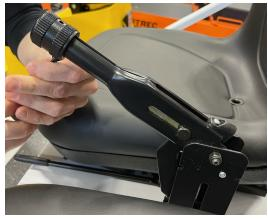
Figure 43. Handbrake Adjustement.
