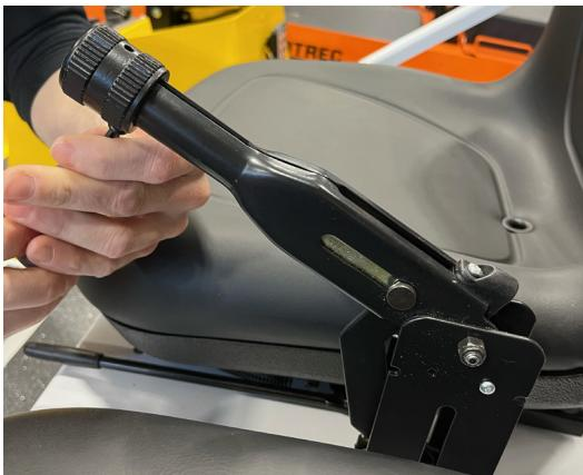
Figure 43. Ajustement du frein à main.
